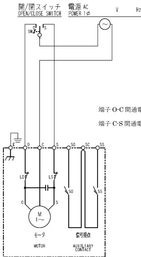
図 6 : B 形内部接続図
