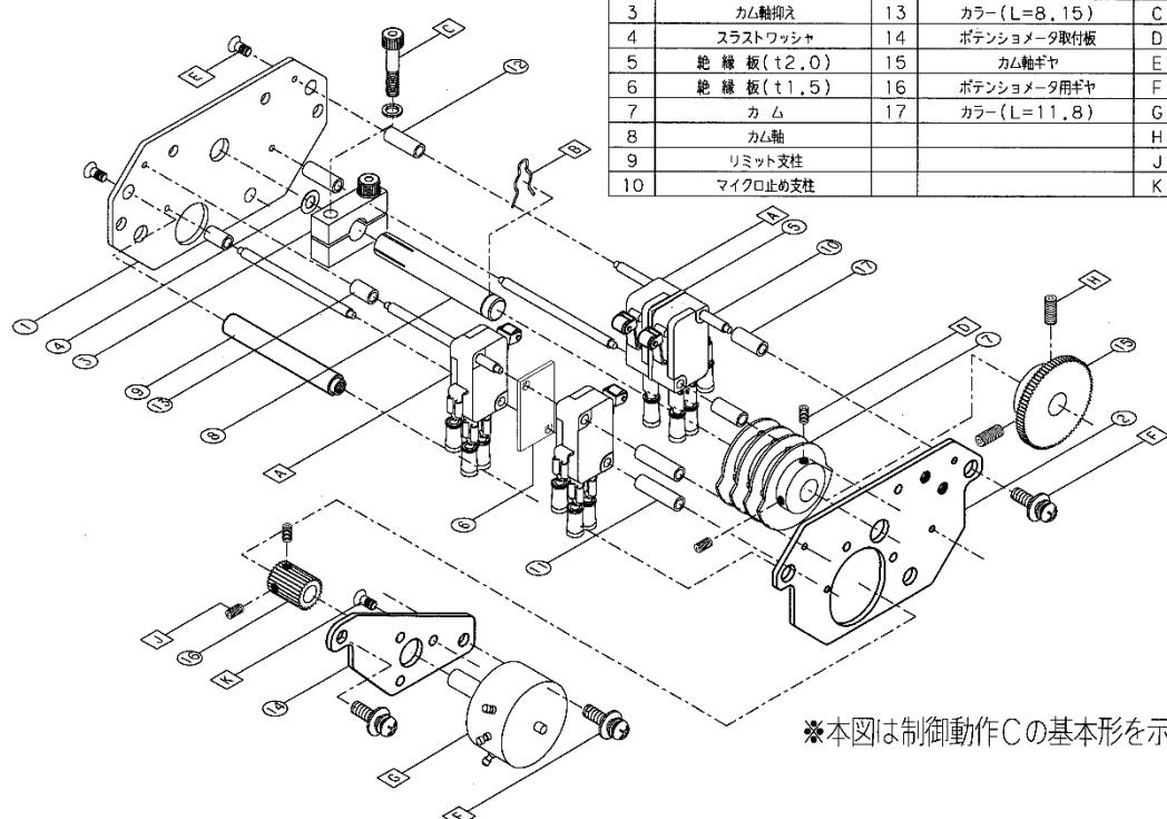
図 1 2 : スイッチ部の構造
