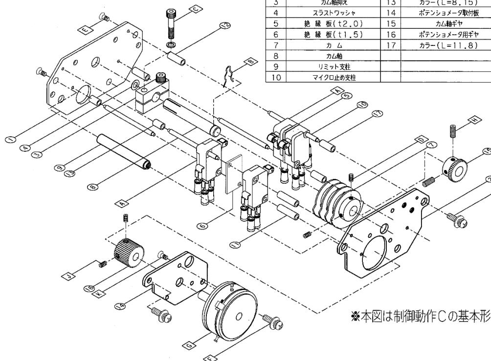
図12：スイッチ部の構造
