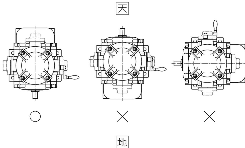
図1：据付け方向の制限
