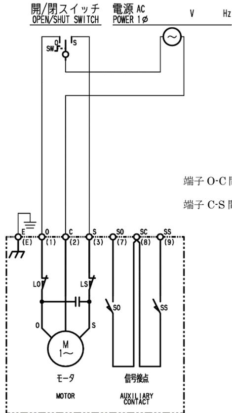
図 6 : B形内部接続図
