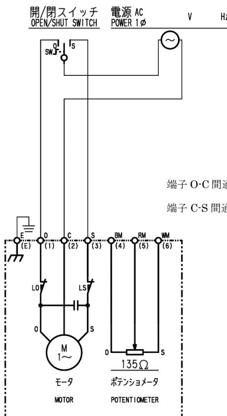
図 6 : C形 (135Ω) 内部接続図
