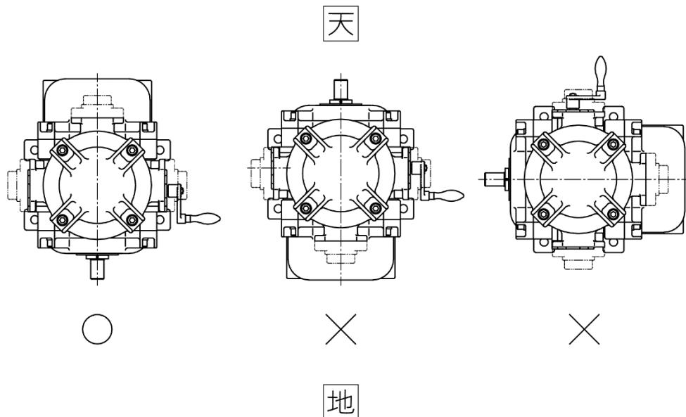
図1：据付け方向の制限
