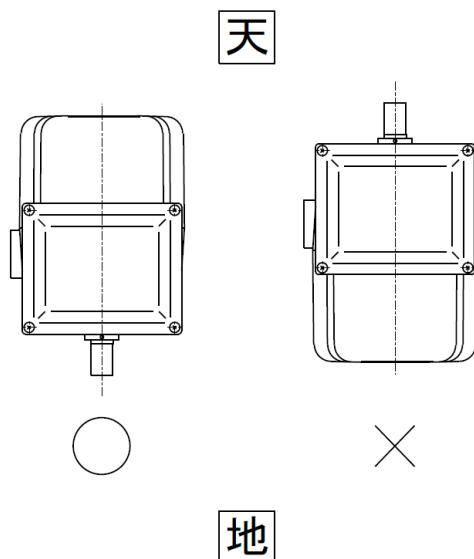
図1：据付け方向の制限
