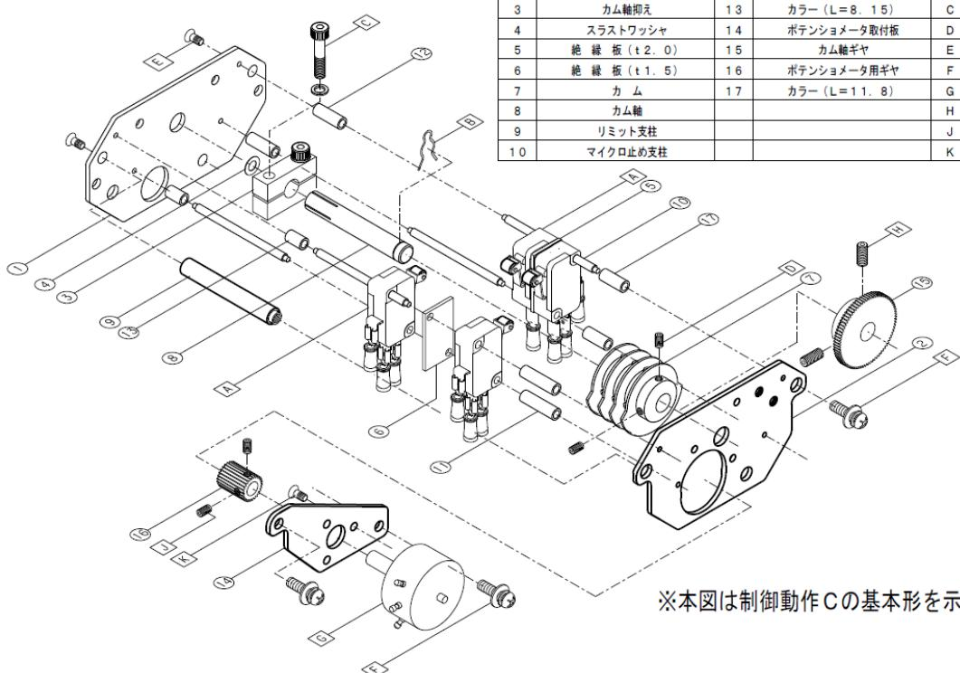
図11：スイッチ部の構造
