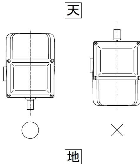
図1：据付け方向の制限
