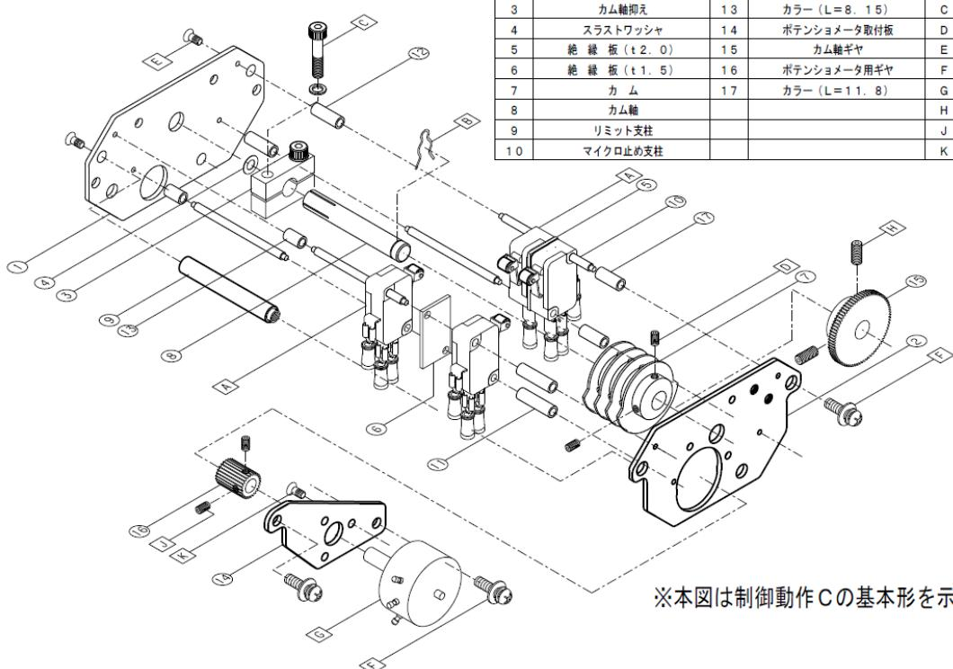
図11：スイッチ部の構造
