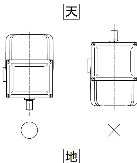
図1：据付け方向の制限
