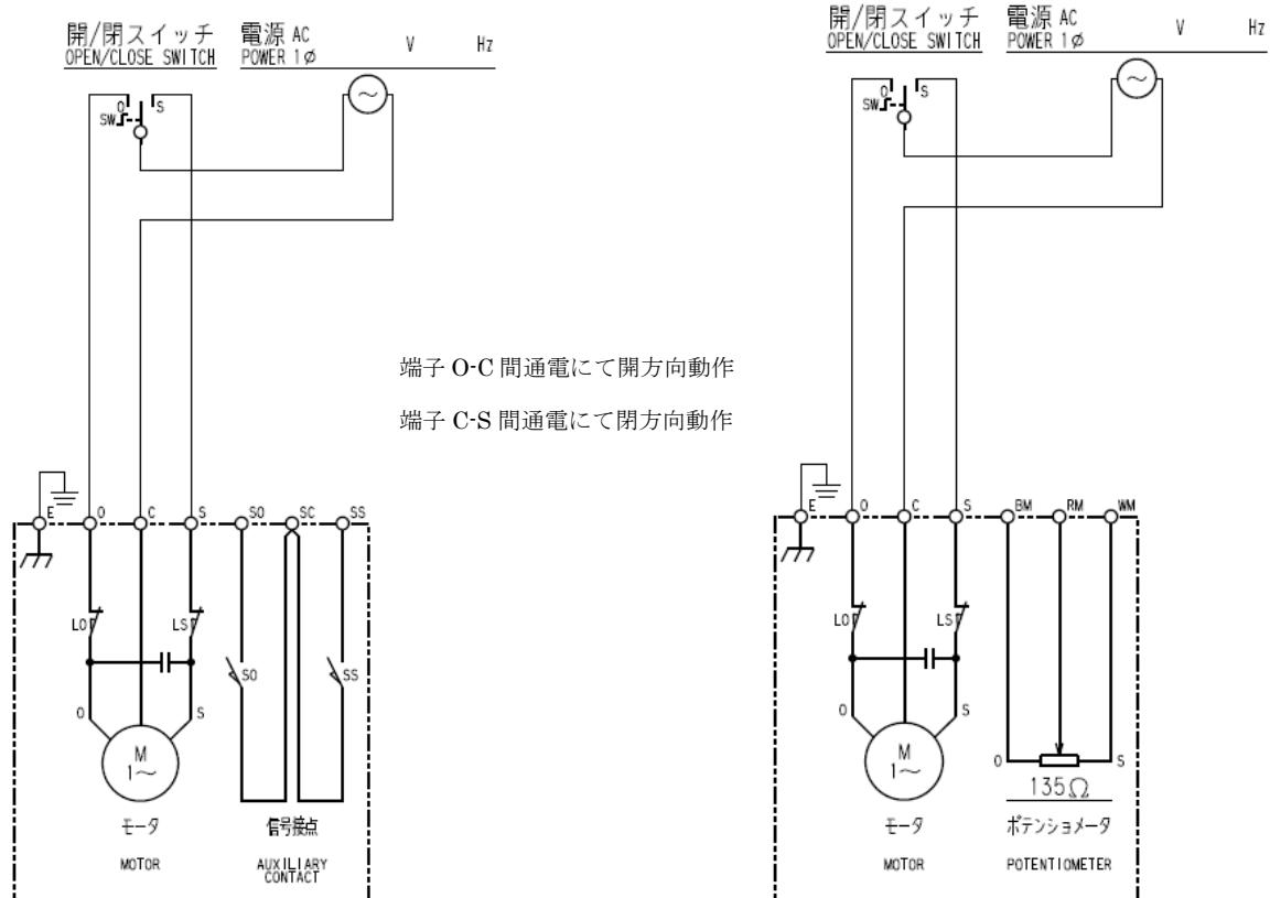
図 5 : B 形内部接続図
