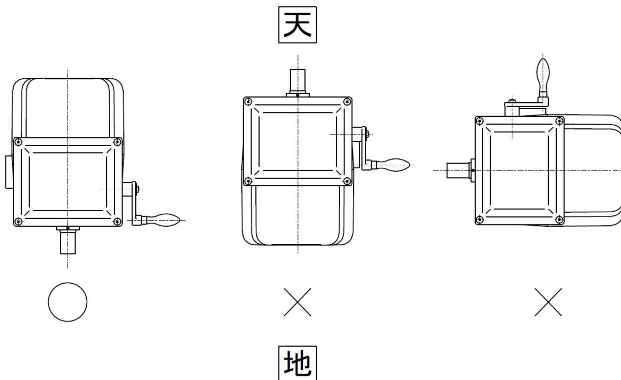
図1：据付け方向の制限
