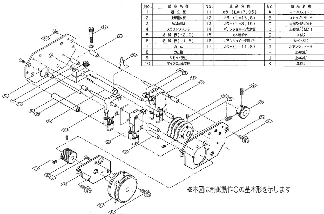
図11：スイッチ部の構造
