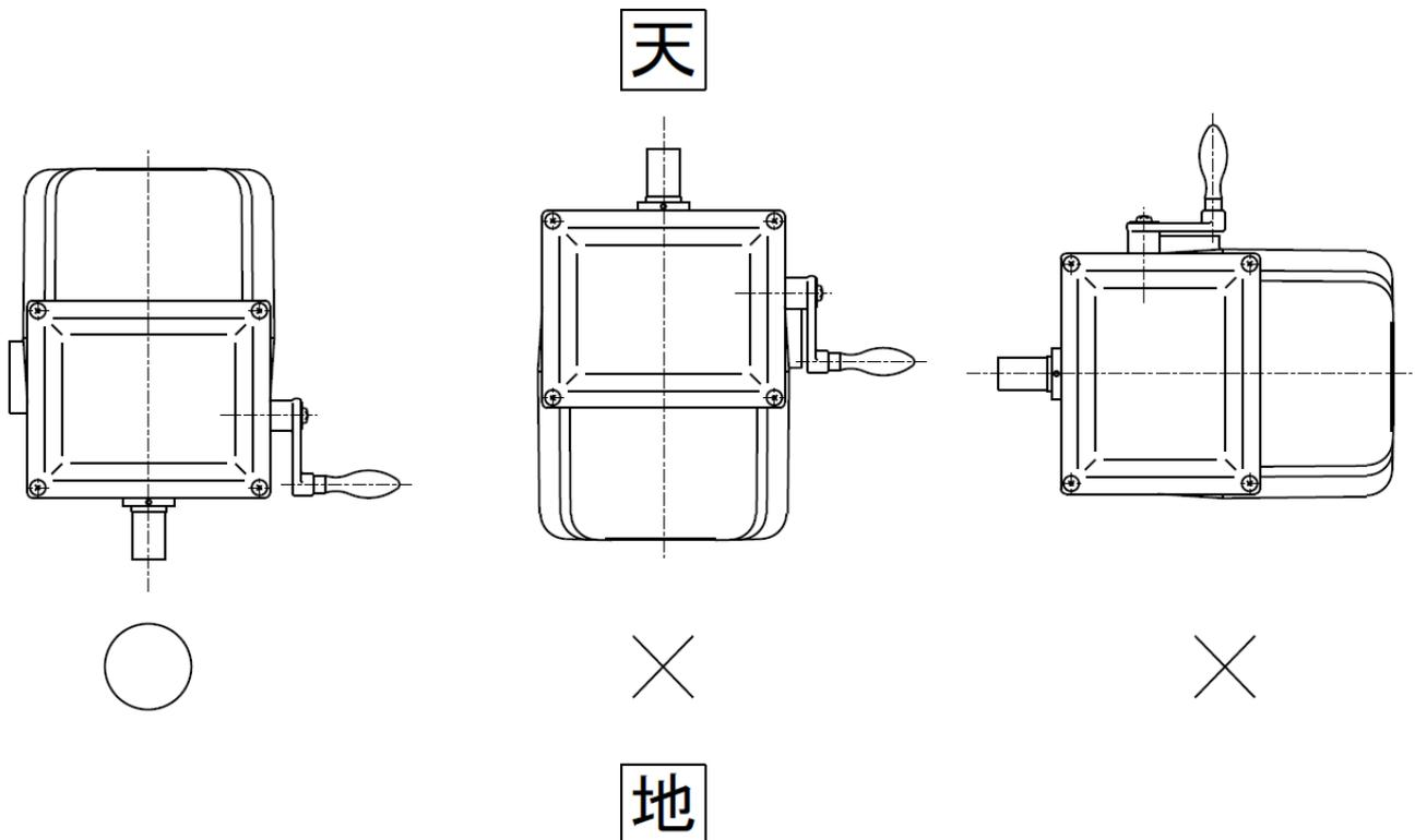
図1：据付け方向の制限
