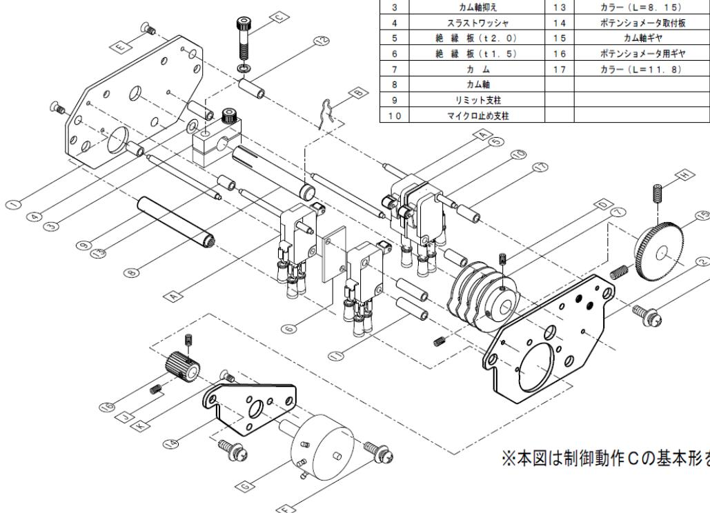
図 11：スイッチ部の構造
