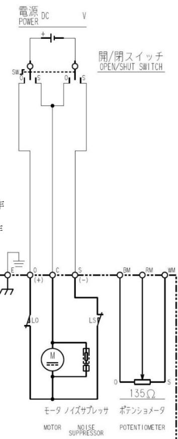
図 5 : B 形内部接続図
