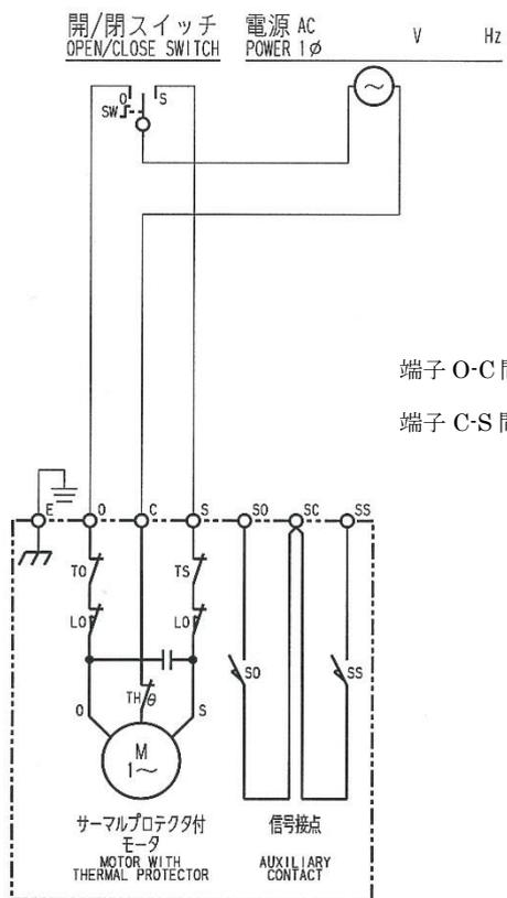
図 6 : B形内部接続図
