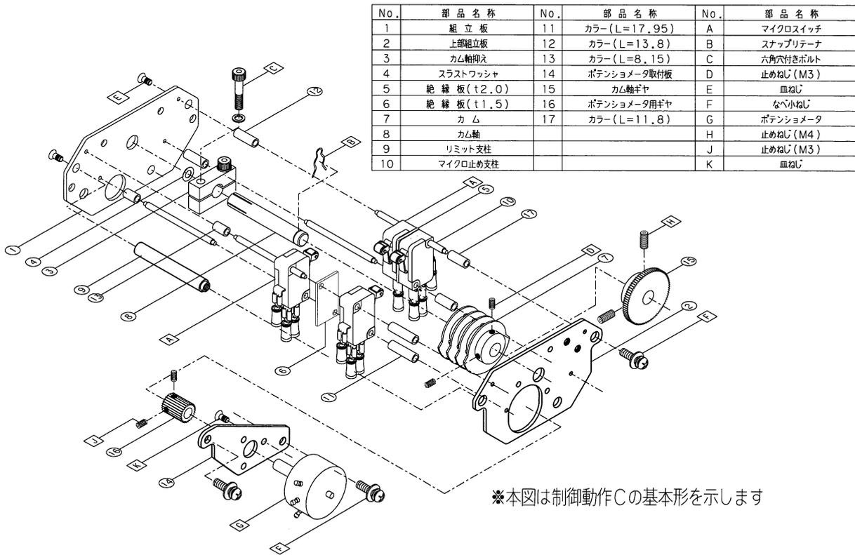
図 1 2 : スイッチ部の構造
