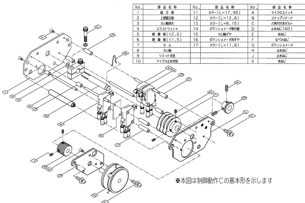
図 11 : スイッチ部の構造
