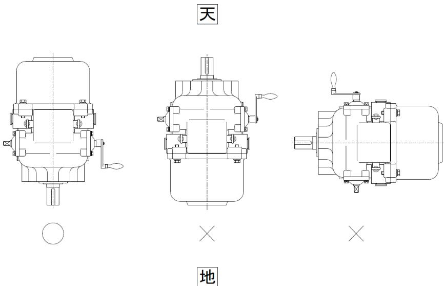
図2：据付け方向の制限
