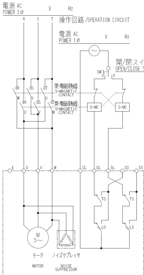
図6：B形内部接続図
