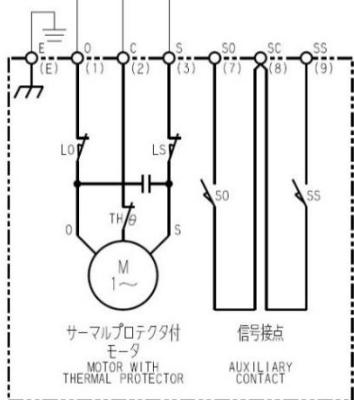
図 7 : B形内部接続図
