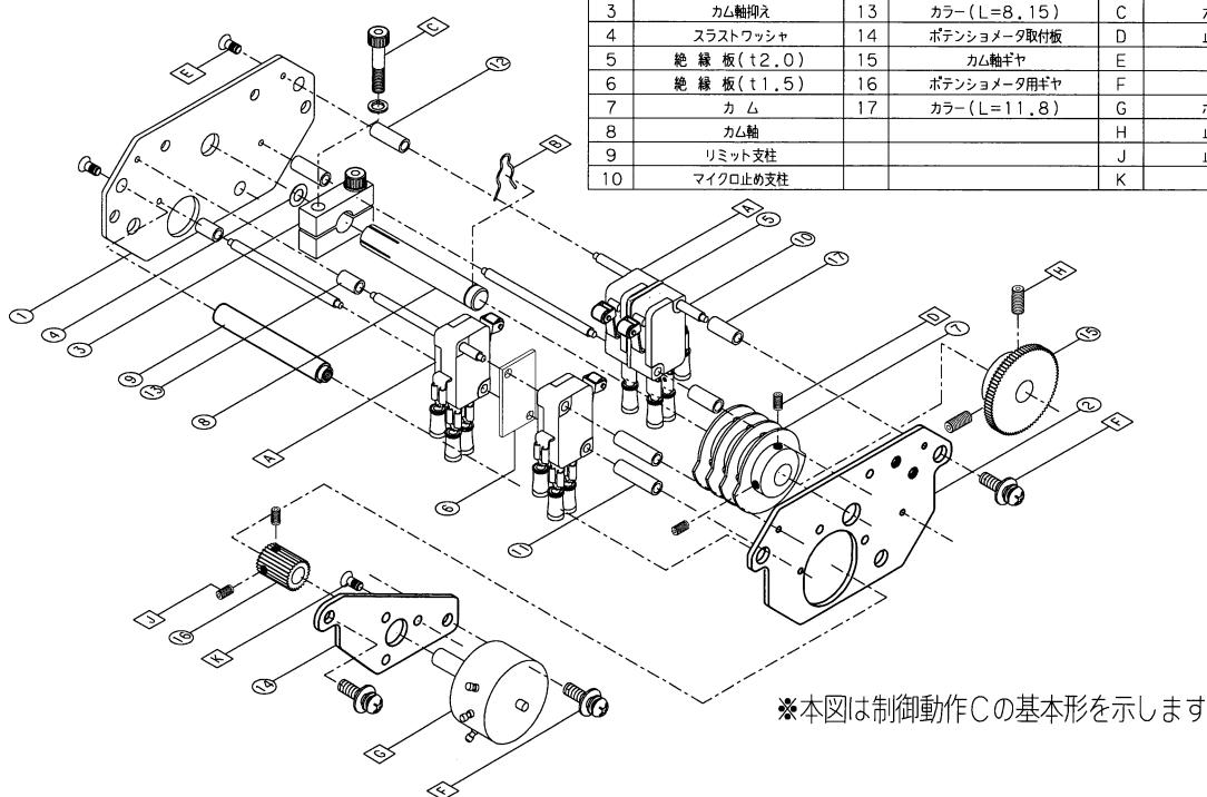
図 1 3 : スイッチ部の構造
