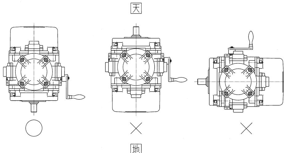
図2：据付け方向の制限
