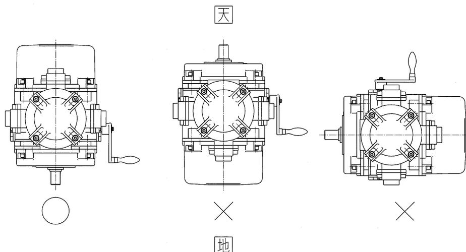
図2：据付け方向の制限
