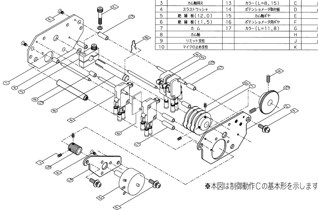
図 1 2 : スイッチ部の構造
