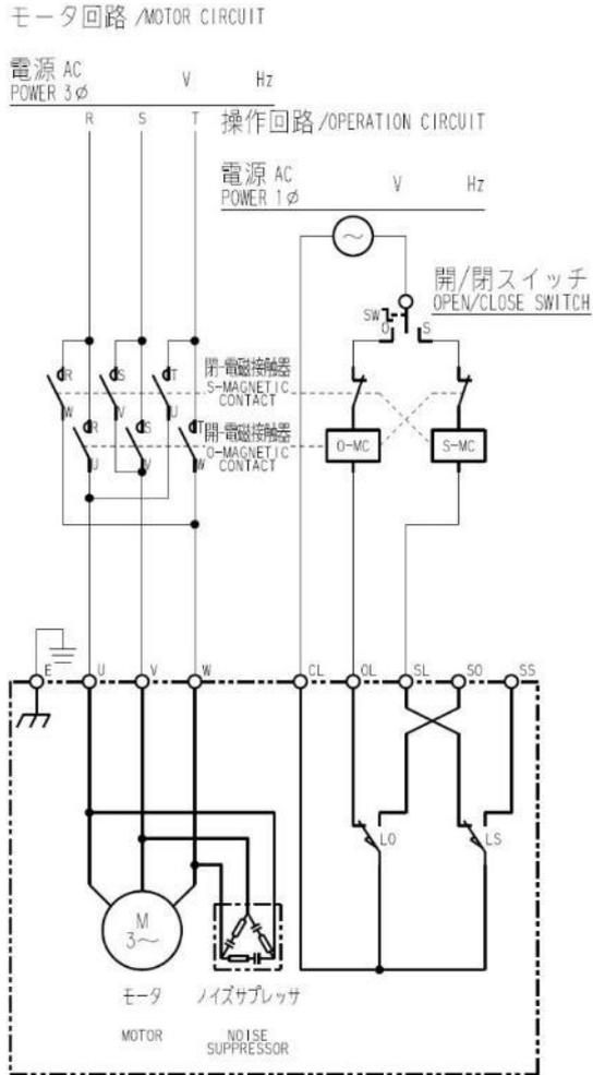
図 6 : B形内部接続図
