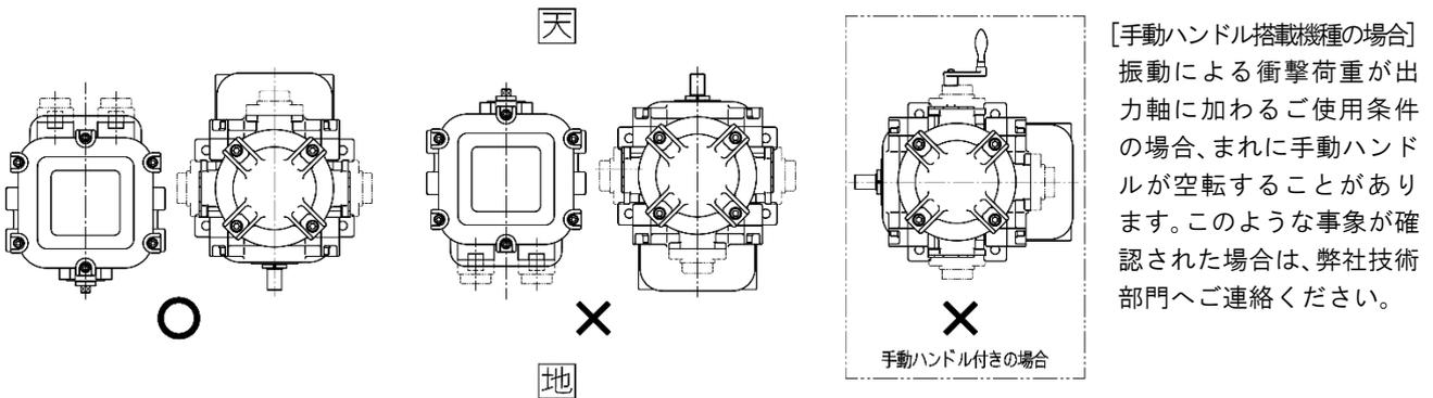
図2：据付け方向の制限
