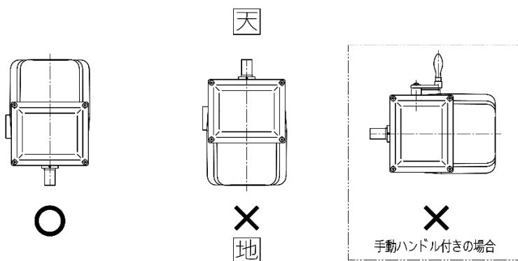
図2：据付け方向の制限
