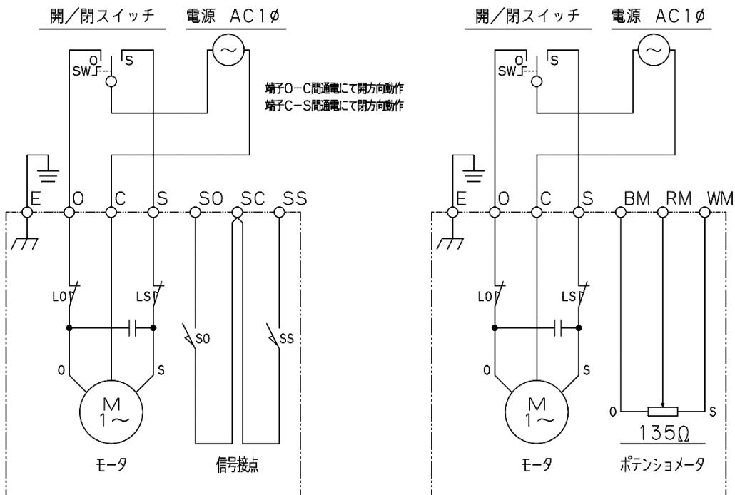
図 6. B 形標準内部接続図 及び C 形標準内部接続図
