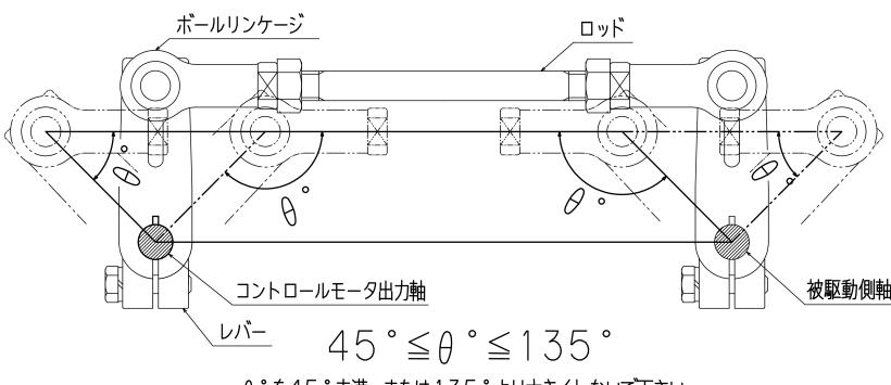
図4：レバーリンクの角度
