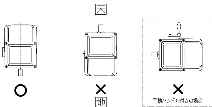
図2：据付け方向の制限
