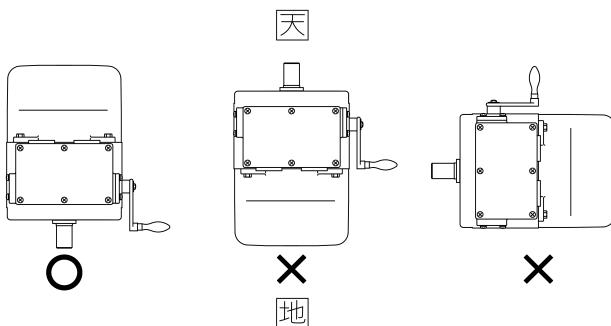
図2：据付け方向の制限
