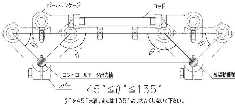
図4：レバーリンクの角度
