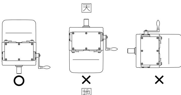
図2：据付け方向の制限
