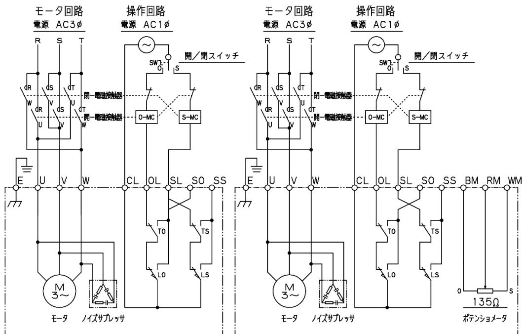
図6. B形標準内部接続図 及び C形標準内部接続図
