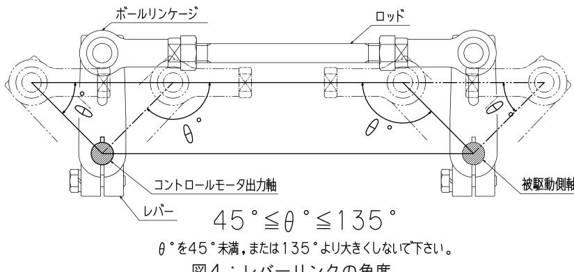
図4：レバーリンクの角度
