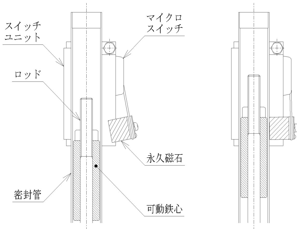
図2. スイッチ動作原理
