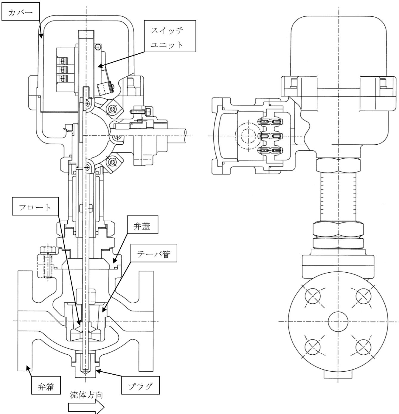
図3. d s A Q - 243形 フローリレー構造図
